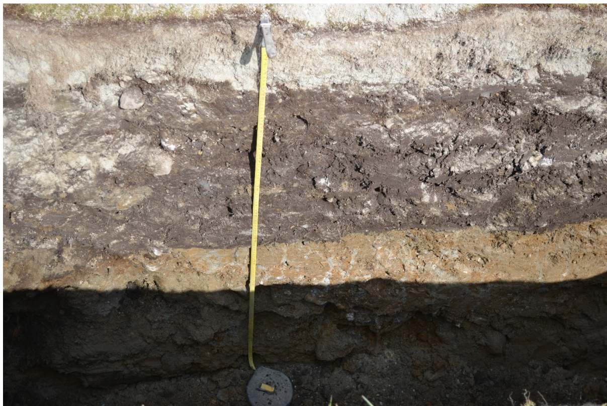
Figur 10: Jordprofil fra Varhaug kirkegård. Profilet hadde svært skarpe sjiktgrenser, som begrenser både vanntransport og luftutveksling. Foto: Trond Knapp Haraldsen.
