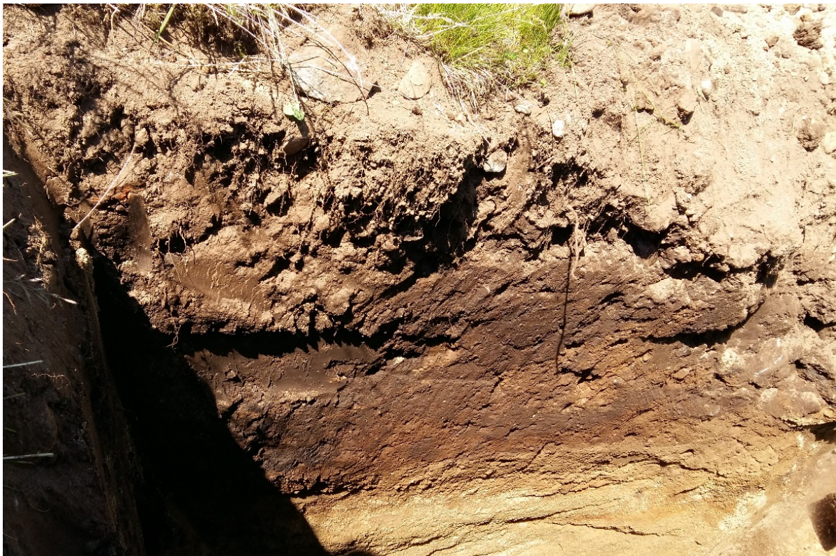
Figur 11: Jordprofil på Nærbø kirkegård, preget av sand med svært jevn overgang mellom sjiktene. Foto: Inghild Halvorsen Økland.
